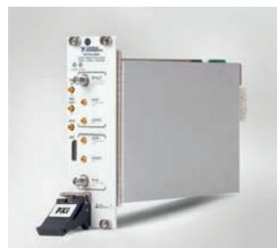
MMPX-Verbinder für bis zu 67 GHz als Schnittstelle in National Instruments Vektorsignal-Messgeräten der neuen Generation
